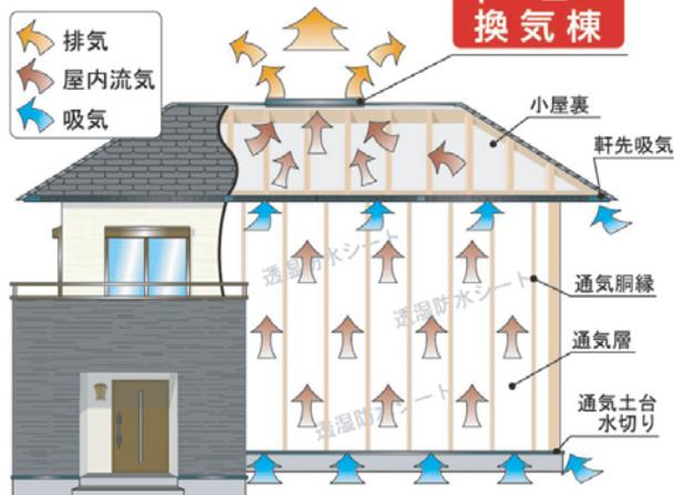
「通気土台水切り」や「軒先吸気」から新鮮な空気を取り込み「換気棟」から湿気を含んだ空気を外に排出します。
