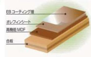
電子線を照射することにより、樹脂を硬化させる技術。ワレタンやUV樹脂コーティング製品に比べ、「傷や汚れ、日光などに強い。高耐久で実用性能、品質安定性に優れた次世代型環境対応技術。
