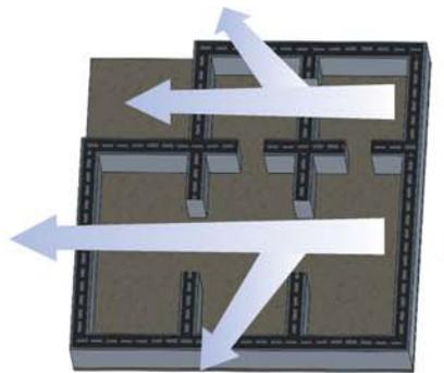
土台スペーサーによる全周換気によって床下の湿気を排湿し、適度な乾燥が土台の腐れも防いで住宅の耐久性を高めます。
